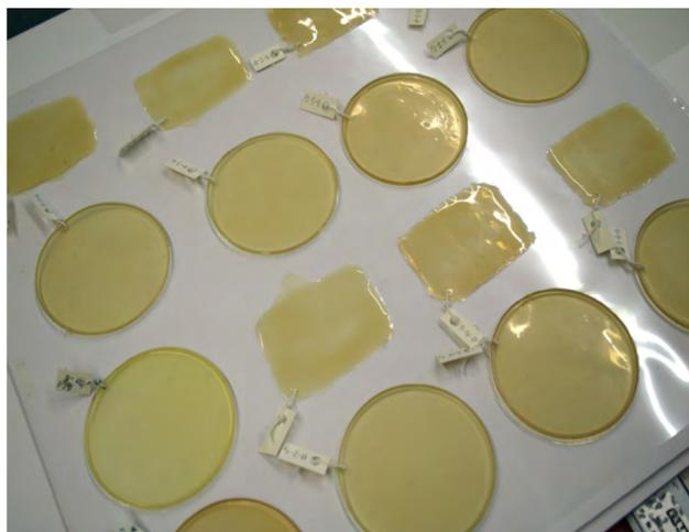
Abb. 2: Latexprouben, mit unterschiedlichen Rezepturen und Dosierungen, erstellt für einen Langzeitversuch (Elisa Carl, 2020)
