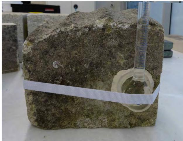
Abb. 2: Messung des Wassereindringverhaltens nach Karsten vor und nach der Behandlung der Steinoberfläche (Foto: Matthias Kocsis, 2019)
